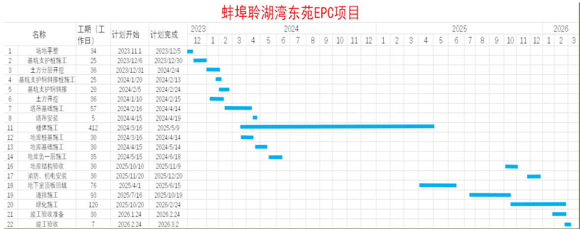
图 2.13 主体工程施工进度横道图
