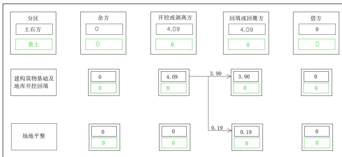
图 1.5-2 已完成土石方平衡框图
